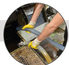
Tauchpumpe für das gleichzeitige Absaugen und Abpumpen der Flüssigkeit - „MPI“ - Modelle
