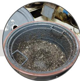
Spänekorb für die Trennung von Metallspänen und Ölen
