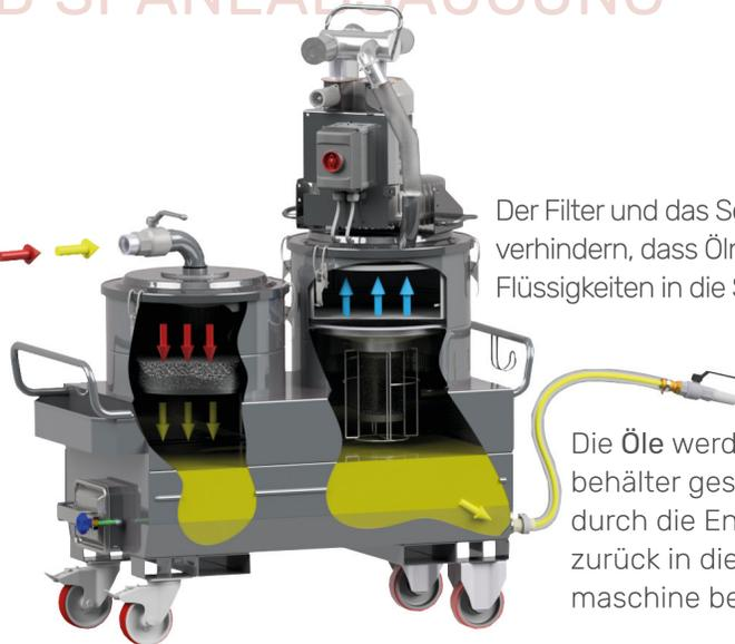
Die Öle werden im Sammelbehälter gesammelt und durch die Entleerungspumpe zurück in die Bearbeitungsmaschine befördert.
