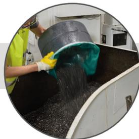
Praktische Entleerung der Späne aus dem Spänekorb oder dem herausnehmbaren Sammelbehälter
