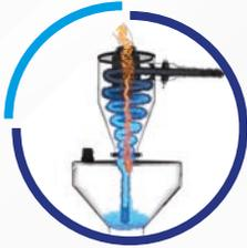
Zyklonischer Vorabscheider separiert bis zu 98%\* des Pulvers
