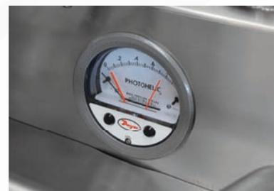
**OPT.** Differenzdruckmessgerät Photohelic
