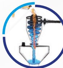
Zyklonischer Vorabscheider separiert bis zu 98%\* des Pulvers
