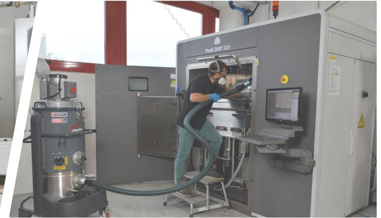
Wartung von 3D-Druckmaschinen
