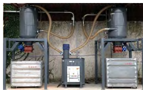
Beispiel: Filter-Vorabscheider mit Zellenradschleuse
