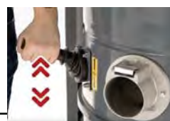
manuelle Abreinigung Filterabreinigung
