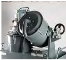
Spänebehälter einfache Entleerung durch Kurbel- Kippsystem
