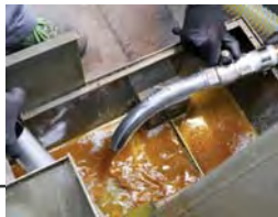
schnelle Entleerung der gereinigten Flüssigkeit
